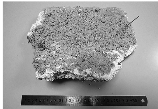
愛知県大治町の町立大治小学校体育館で発生した天井吹付材の剥離事故（2015年5月）
